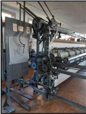
Mis au point en 1869, il fonctionne grâce à un *pantographe* dirigé par un *brodeur* qui exécute chaque point de broderie en faisant glisser un chariot garni d'aiguilles : pas de moteur, pas d'électricité, tout est mécanique et fonctionne à la force des bras et des jambes. Son rendement est de 6-7 points/minute. Chaque aiguille, à deux pointes, est enfilée avec un fil coupé à dimension. Ce métier reproduit les gestes de va-et-vient de la brodeuse.
