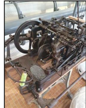
Ce métier fera place à une machine (mise au point en 1913 par Saurer) à fil continu (sur bobine) avec aiguilles et navettes. Même principe que la machine à coudre (bobine et cannette), pantographe et moteur d'entraînement.
